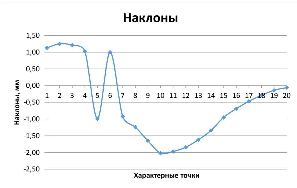
Рисунок 44 – График максимальной зоны наклонов по железной дороге.
