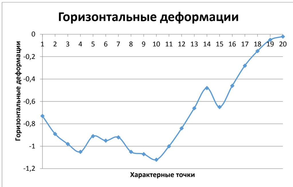
Рисунок 43 – График максимальной зоны горизонтальных деформаций по железной дороге.
