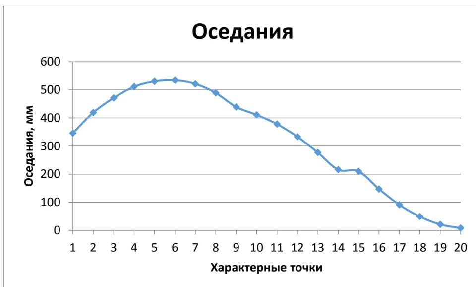
Рисунок 42 – График максимальной зоны оседания по железной дороге.
